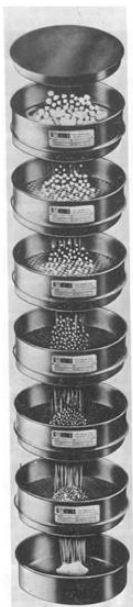
Figura 10. Serie di setacci sovrapposti e agitati per separare le diverse classi granulometriche.
