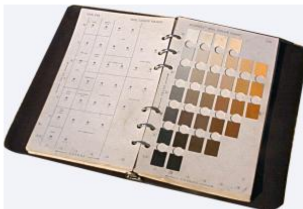
Figura 10. Sistema Munsell: un campione di terreno è paragonato alle diverse sfumature cromatiche ponendolo a confronto tramite dei fori posti vicino ad ogni tonalità.
